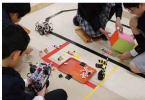
踏切では、「ランプが交互に点滅する」 「バーが下る」「ブザーが間隔を置いて鳴る」 3つの回路が組み立てられている...
